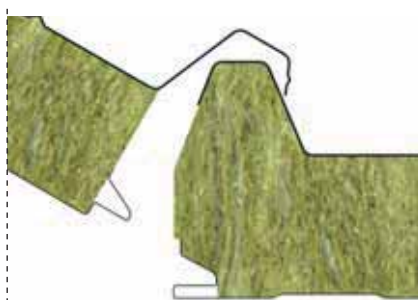
Detaliul fazei de montaj
